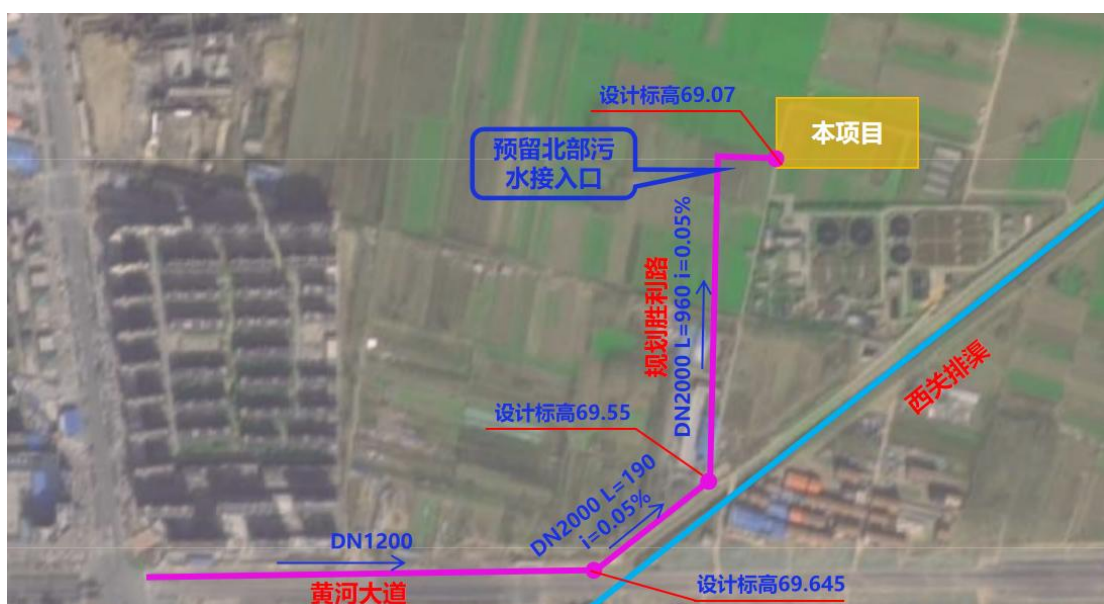
图 2-2 项目接入口处管网图
