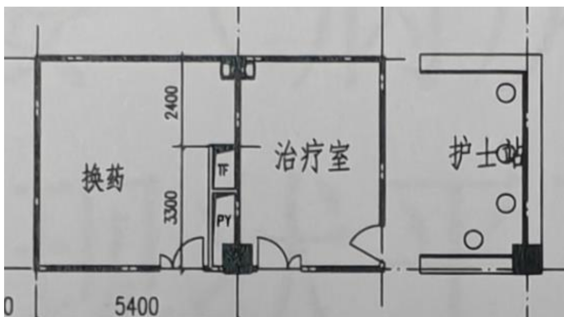
(三)、2 号楼 15 层治疗室及换药室图纸 治疗室：3.9m*5.7m ;换药室：5.4m*5.7m
